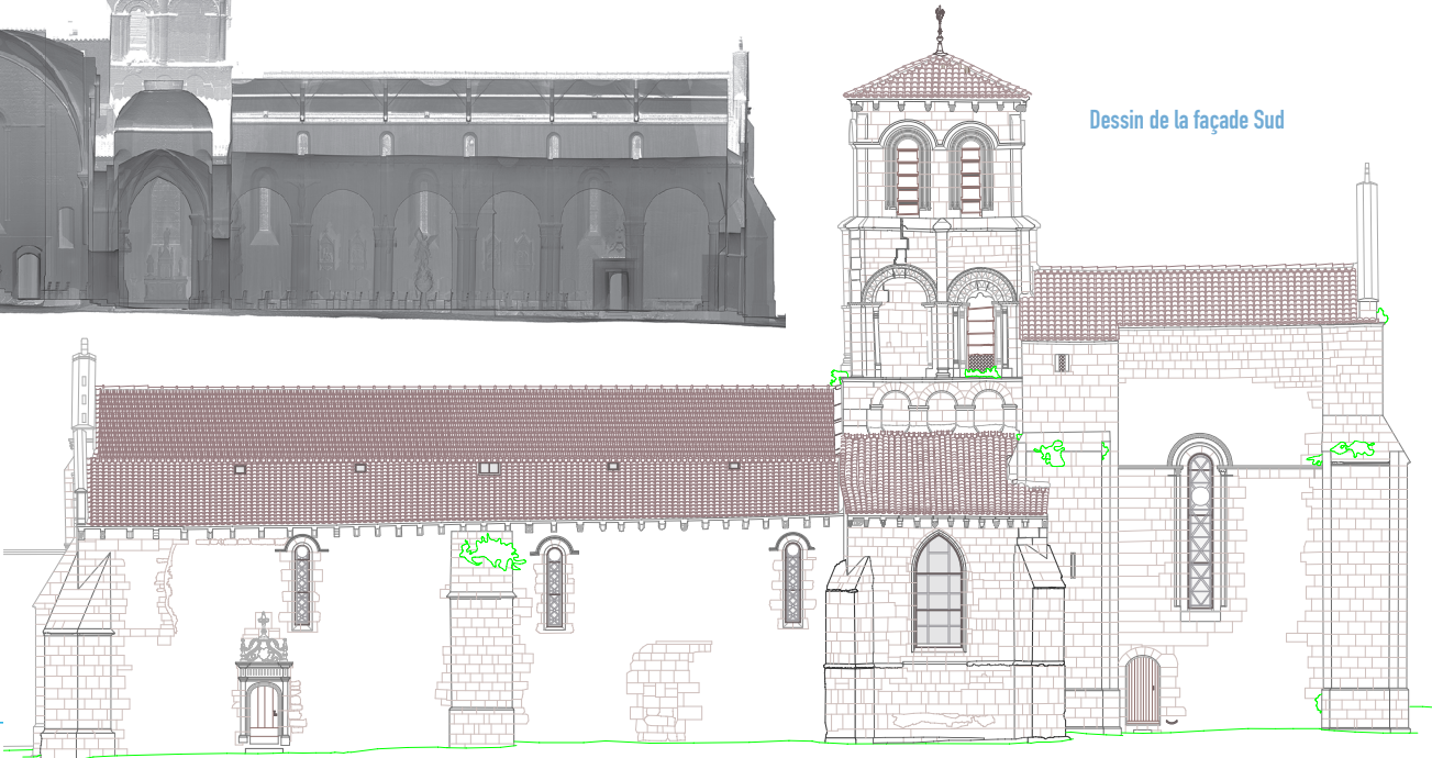
Coupe longitudinale dans le nuage de points du géomètre
