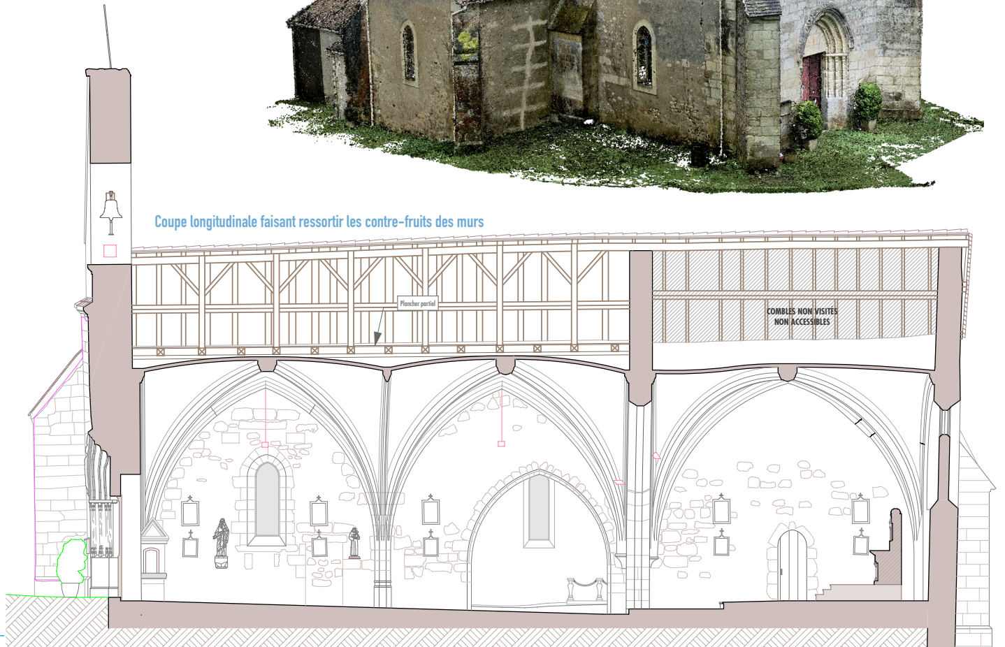
Vue en perspective du nuage de points extérieur obtenu par prises de vues au téléphone portable
