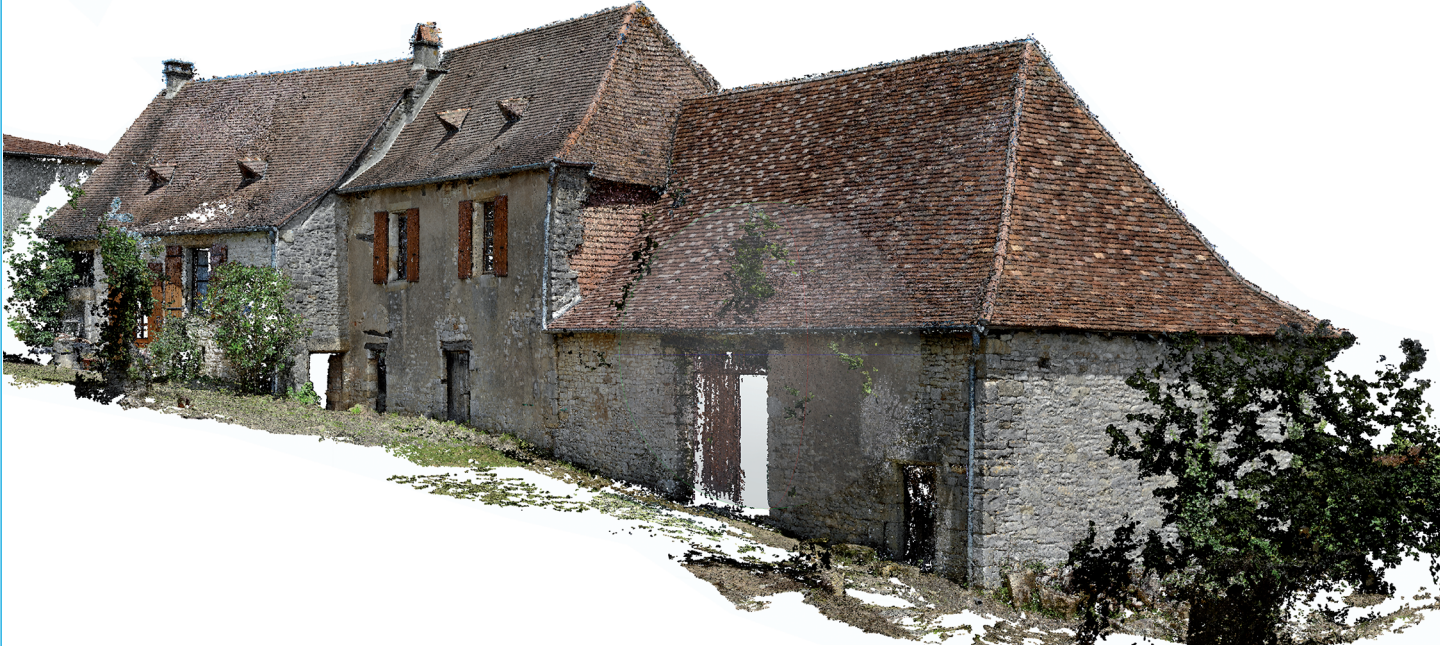
Capture d'écran en perspective conique du nuage de points dense obtenu par captation drone.
